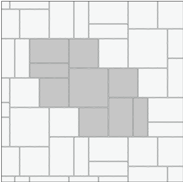
SCHEMA DI POSA 4 FORMATI PAG. 21 Nr. 1 - 80x80 19,04% Nr. 2 - 50x80 23,81% Nr. 4 - 60x60 42,86% Nr. 2 - 30x80 14,28%
